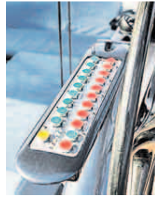
Zahlreiche elektrische Helfer erleichtern auf Knopfdruck das Segeln, sind aber auch störungsanfällig und bringen erhebliches Mehrgewicht
